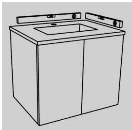
Das Möbel muss gemäß den Empfehlungen unserer Installationsanleitungen perfekt waagrecht installiert werden. Gemäß der Installationsanleitung müssen Sie mit Silikon abdichten. Vor jeglicher Verwendung des Möbels muss das Silikon trocknen.
