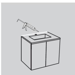
Zwischen dem Waschtischunterschrank und der Wandhalterung muss unbedingt verfügt werden.
