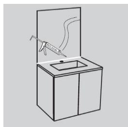
Zwischen dem Waschtischunterschrank und dem Rückwandspiegel muss unbedingt verfügt werden.
