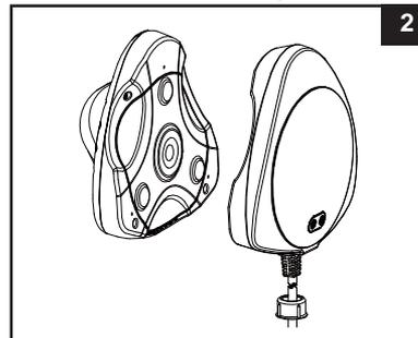
2. Platzieren Sie den Transmitter (2) auf der Außenseite der Poolwand und die Poolbeleuchtung (1) auf der Innenseite der Poolwand, unter Wasser. Versichern Sie sich, dass die Transmittermagnetpole genau mit den Magnetpolen auf der Poolbeleuchtungseinheit ausgerichtet sind. **Siehe dazu Zeichnung (3).**
