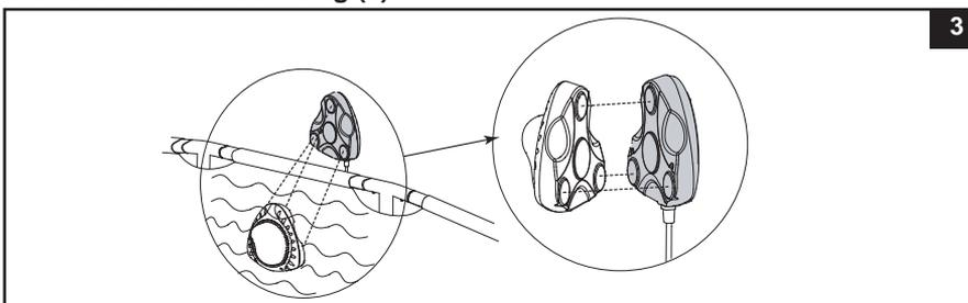
3. Stellen Sie die Position der Poolbeleuchtung ein, indem Sie die Transmitterposition manuell seitlich und/oder vertikal verschieben.
