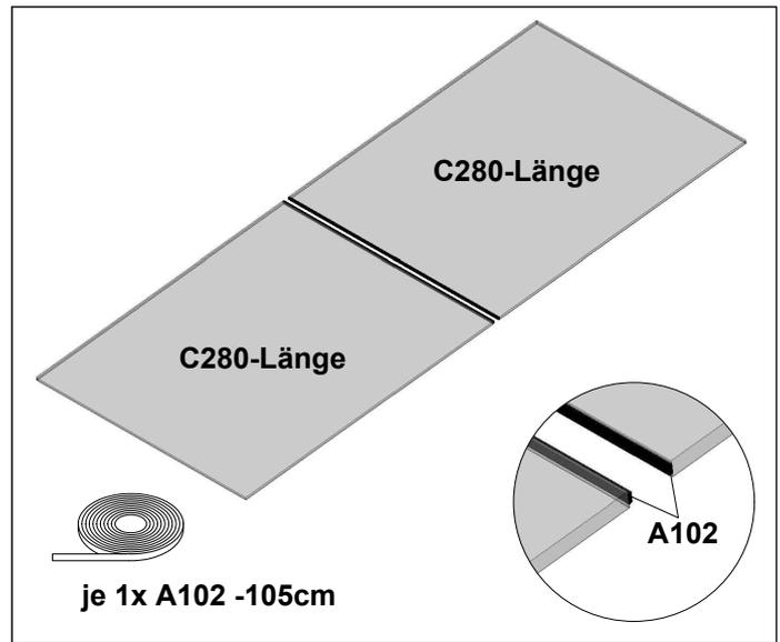
Dichtgummi in die Aluprofile einziehen und die Aluprofile mit einem 5mm Metallbohrer in einem gleichmäßigen Abstand für die Schrauben C104-0045 vorbohren. Dann bekleben Sie die Glasscheiben beidseitig am vorgesehenen Stoß mit dem Dichtband A102.
