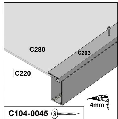
Setzen Sie die Glasleisten UH1,3 / 1,8-200 als Abstandshalter mittig auf die Sparren und kürzen Sie bündig mit dem Sparren ein. Verschrauben Sie nun die auf das Glas gelegten, vorgebohrten Aluminiumprofile mit dem Sparren. Die Abschlußwinkel (C 220) ebenfalls mit 5mm vorbohren und zusammen mit dem Aluprofil auf dem mit 4mm vorgebohrten Sparren montieren.
