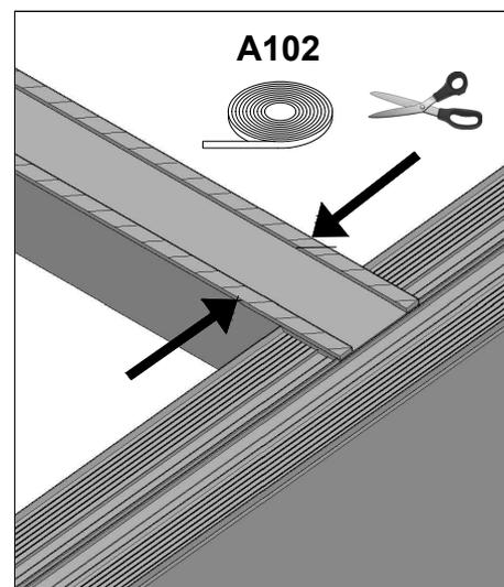
Kleben Sie das Fugenband auf die Enden des Profils der Rinnen- und der Wandpfette auf und schneiden es dann seitlich bündig mit den Sparren ab. Dann kleben Sie das Fugenband jeweils beidseitig an der Außenkanten der Hohlprofile für den Glasstoß entlang.
