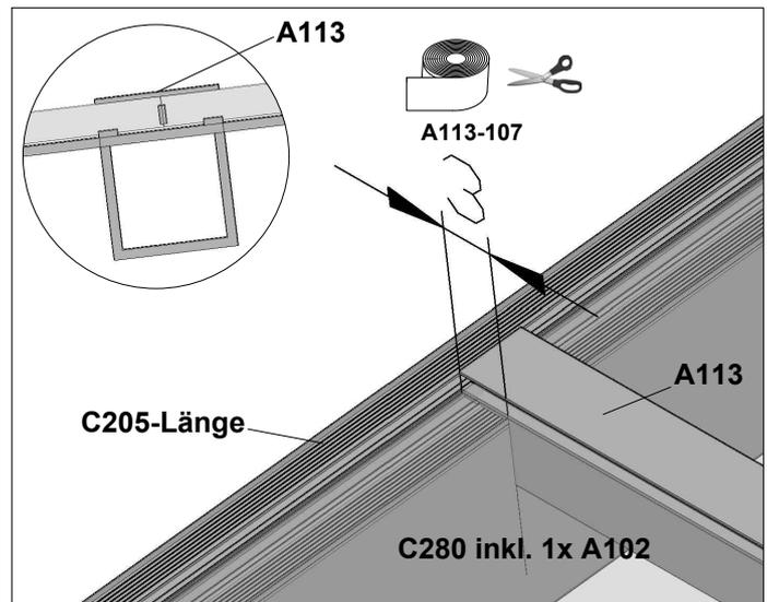
Legen Sie die Glasplatten auf den mit 4mm vorgebohrten und mit dem Unterlegband versehenen Sparren. Dann bringen Sie das Butylband A113 mittig auf den Glasstoß auf.
