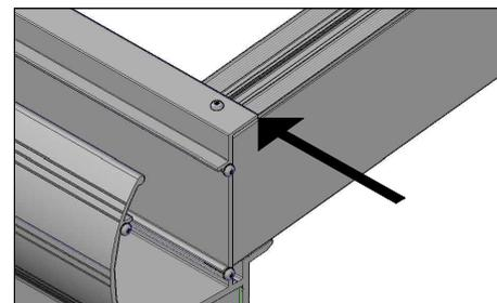
Das Unterlegband mit Hilfe des doppelseitigen Klebenbandes auf den Sparren verlegen. Lassen Sie das Unterlegband für die Sparren bündig am Hohlprofil für den Glasstoß und an der Wand- und der Rinnenpfette enden.
