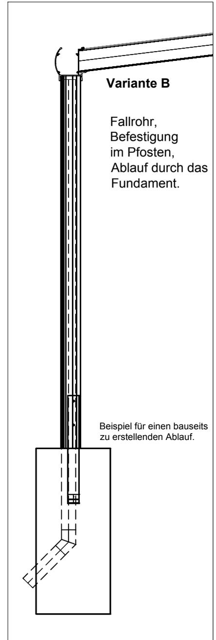
Fallrohr mit Schraubstutzen, Laubfangkorb und Rohrbogen zusammenstecken, ausrichten und verkleben. Mit Hilfe der Clip-Rohrschellen und den Schrauben (C101-025) montieren.
