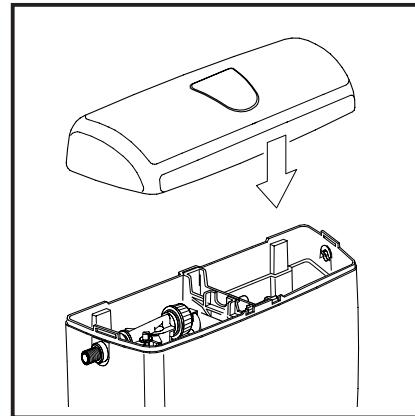
**Option B: waternaansluiting middenachter; Wasseranschluss hinten mittig; water connection back
