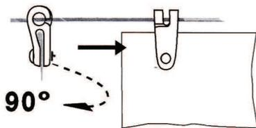
**Sonnensegel mittels Laufhaken, (Drehung um 90°) in Seil einhängen**
