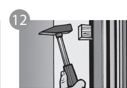
12 Flügel einhängen und den Elementrahmen auf der Verriegelungsseite (Griffseite) zum Flügel hin ausrichten (Flügel muss komplett am Rahmen anliegen). Rahmen mit Keilen fixieren.
