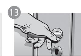
13 Funktionsprüfung durchführen (schließt und öffnet das Element richtig?), gegebenenfalls Korrekturen durch Nachsetzen der Keile vornehmen.
