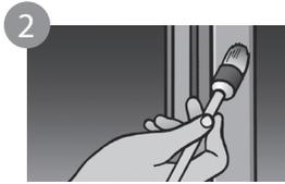
2 Imprägnierung ist keine Oberflächen-Endbehandlung. Behandeln Sie alle Elemente aus Holz vor dem Einbau umlaufend mit Lacken und Lasuren, die für maßhaltige Holzbaustoffe geeignet sind (z. B. Fenster-/Türen-Lasur)! (Rahmen und Flügel rundherum auf allen Seiten, Beschläge und Dichtungen nicht überstreichen). Silikon ist eine Wartungsfuge und muss bei Undichtigkeit erneuert werden. Silikon ist nicht überstreichbar.
