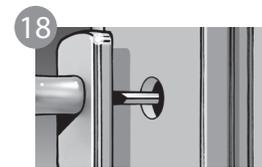
18 Beschlag, gegebenenfalls Profilylinder, montieren. Vergewissern Sie sich, dass beim Bohren für die Befestigung des Beschlages das Schloss oder andere bewegte Teile nicht beschädigt werden.
