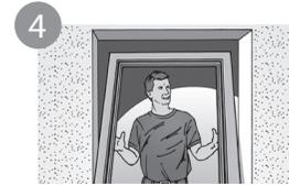
4 Elementflügel aushängen. Stellen Sie den Elementrahmen (Öffnungsrichtung beachten, Bandseite ist die Innenseite, sofern nicht anders bestellt) in die Maueröffnung.
