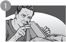
1 Element auspacken und die Beschaffenheit sowie Ausführung auf Mängel prüfen, gegebenenfalls auch unter der Schutzfolie. Bei Mängeln darf das Element nicht eingebaut werden!
