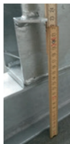
Adâncimea de introducere a montanțului de oțel (cca. 22,5 cm)
