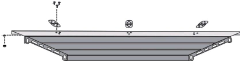
Stecken Sie die Abdeckungen der Randelementabschnitte auf das Randelement. Befestigen Sie sie mithilfe der Schrauben.
