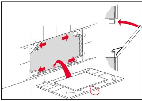
ALPRO 2000 mit Einhängetechnik und Ausklink-Sicherung ist ein „Spitzenprodukt“ für unsichtbare Revisionsklappen in Fliesenwänden.
