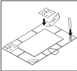
Metallstreifen, Einhängevorrichtung und Schnur aufkleben. Mehrere Fliesen mit geeignetem Material zusammenkleben (Silikon).
