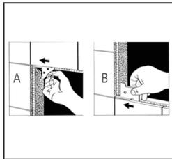
Magnetwinkel (A) und Einhängehalterung (B) bei noch weichem Fliesenkleber in die Fliesenfugen einsetzen.
