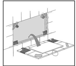
Abdeckung einhängen und schließen. Öffnungskordel in die Fliesenfuge einlegen.
