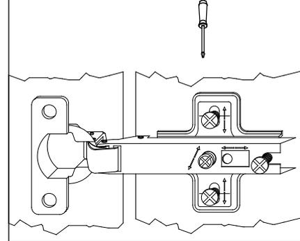
T11 Bei Türmontage das Scharnier einhängen, bis Anschlag öffnen und anschließend festschrauben.
