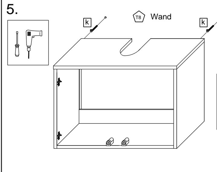
**T6** Die Schrankaufhänger dienen zur Kippsicherung des Schrankes und müssen grundsätzlich montiert werden.
