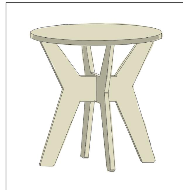
Richte die Tischplatte so aus, dass sich die Fußteile in die Aussparungen der Tischplatte einstecken lassen. Mit leichten Hammerschlägen (einen weißen Gummihammer verwenden!) die Platte mit den Fußteilen verbinden. Je nach Verwendung muss das Holz mit einem schützenden Anstrich versehen werden.
