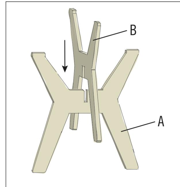
Stelle das Fußteil (A) so auf, dass die beiden angefrähten Enden und der Schlitz nach oben zeigen. Beim zweiten Fußteil (B) zeigt der Schlitz nach unten. Stecke beide Teile soweit zusammen, bis sie an den Schlitten vollständig zusammengefügt sind.
