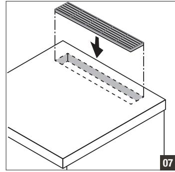
**DE:** Wandabschlussprofil **EN:** Wall seal profile **FR:** Profil de finition murale **NL:** Wandprofiel **ES:** Copete mural **CS:** Profil ukončení stěny **HU:** Falvégprofil **DA:** Vægafslutningsprofil **IT:** Listello coprifilo **PL:** Listwa przyścienna
