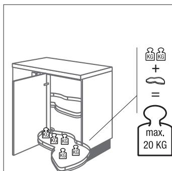
**DE:** Maximale Belastbarkeit **EN:** Maximum load capacity **FR:** Capacité de charge maximale **NL:** Maximaal laadvermogen **ES:** Capacidad de carga máxima **CS:** Maximální zatížení **HU:** Maximum töltés **DA:** Maksimal belastning **IT:** Capacità di carico massima
