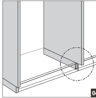
**DE:** Lüftungsgitter **EN:** Ventilation grilles **FR :** Grille d'aération **NL:** Ventilatierooster **ES:** Rejilla de ventilación **CS:** Ventilační mřížka **HU:** Szellőzőrács **DA:** Ventilationsgitter **IT:** Griglia di aerazione **PL:** Kratka wentylacyjna **RO:** Grilaj de aerisire **RU:** Вентиляционная решетка **SK:** Vetricia mriežka **SL:** Prezračevalna rešetka **TR:** Havalandırma izgarası **ZH:** 通风格栅
