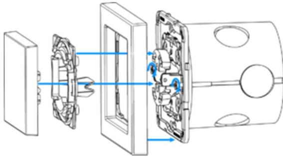
1. Stecken Sie das Gerät mit Montagerahmen in die Montagebox und sichern Sie es mit Befestigungskralen und Schrauben.
