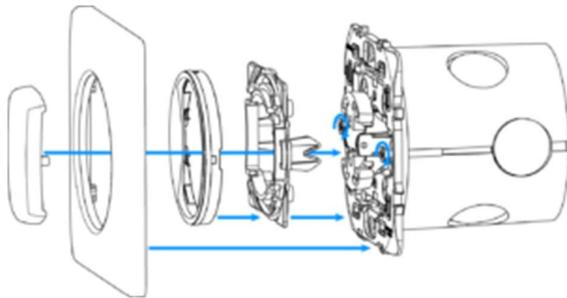
1. Setzen Sie das Gerät mit Montagerahmen \* in die Montagedose ein und sichern Sie es mit Montagekralen und Schrauben.
