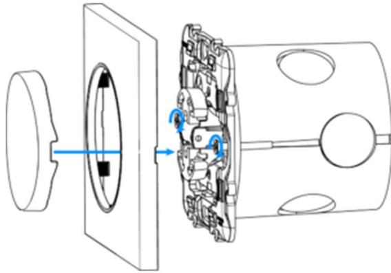
1. Stecken Sie das Gerät mit Montagerahmen\* in die Montagebox und sichern Sie es mit Befestigungskrallen und Schrauben.
