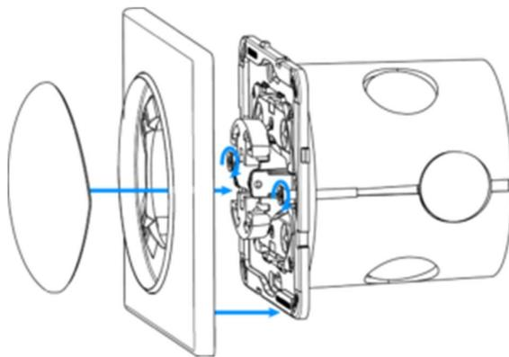
1. Setzen Sie das Gerät mit Montagerahmen in die Montagedose ein und sichern Sie es mit Montagekrallen und Schrauben.
