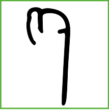
25 und 27 Clipprofil Dach unten und Regenrinne 25 and 27 Roof clip profile section below and rainwater gutter 25 et 27 Profilé à clipser inférieur de toit et gouttière 25 en 27 Clipprofil dak onderaan en regengoot
