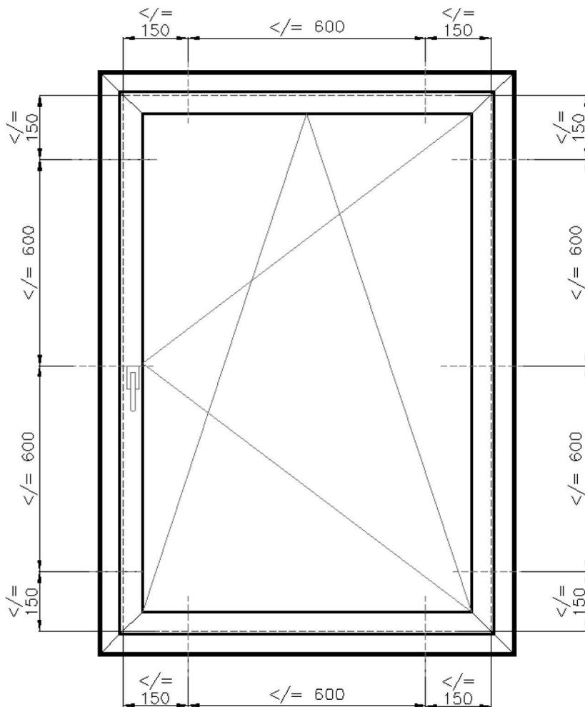
Befestigungsabstände aus der Rahmeninnenecke: max. 150 mm (gilt auch bei Einsatz von Sprossenprofilen) bei Fenstern Befestigungsabstand untereinander max. 600 mm
