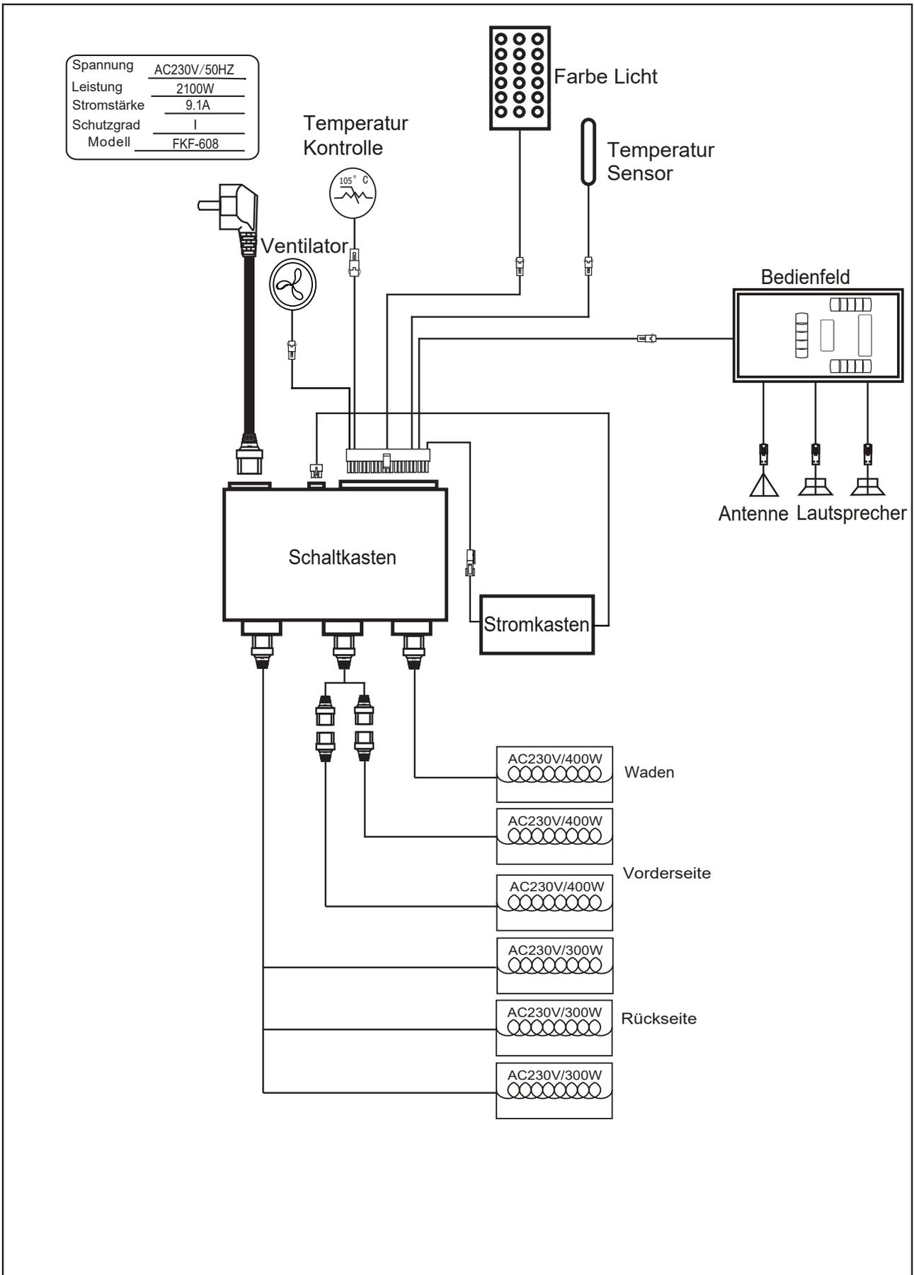
Schließen Sie das Netzteil an die Steckdose an, die LED-Anzeige beginnt auf dem Display zu blinken. Jetzt ist es möglich, die Infrartheizungen, das Licht und die Musikfunktion einzuschalten.
