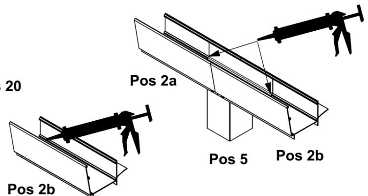
Montieren Sie die übrigen Zwischenträger maßgerecht entsprechend den in der Skizze angegebenen Maßen, die Erhöhungsprofile mit der lange 723 mm funktionieren wieder als abstandhalter
