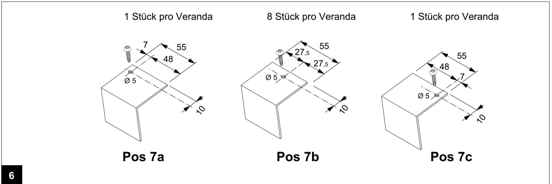
Bohren Sie die Plattenstopper vor, wie in den obigen Detailskizzen beschrieben.
