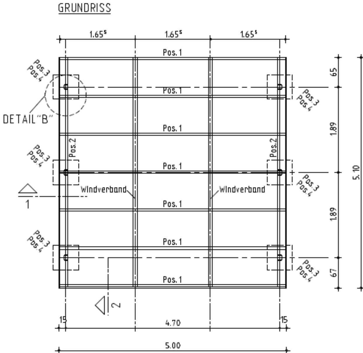
Legen Sie die Sparren auf die Tragbalken und befestigen Sie diese wechselseitig mit den HVV Winkeln, die Sie wiederum mit Spax-Schrauben 4x30 mm befestigen (siehe Skizze Nr. 2).
