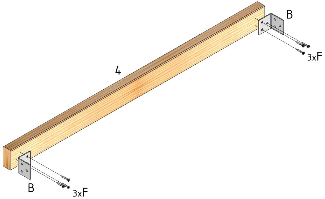
An Strebe (4), die Winkel (B) mit Schraube (F) befestigen
