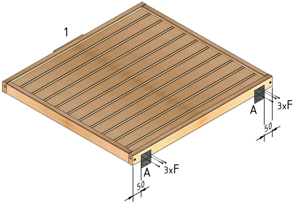
An Deckel (1) mit der Schraube (F) die Scharniere (A) anbringen
