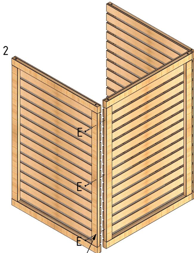
Alle Löcher  $\varnothing 5$  mm vorbohren
