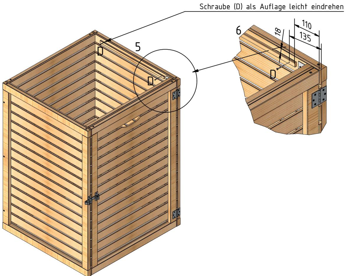
Deckelstütze (5) mit der Schraube (D) leicht fixieren, sodass die Leiste sich drehen kann.
