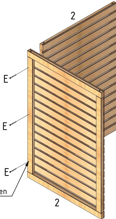
Alle Löcher  $\varnothing 5$  mm vorbohren
