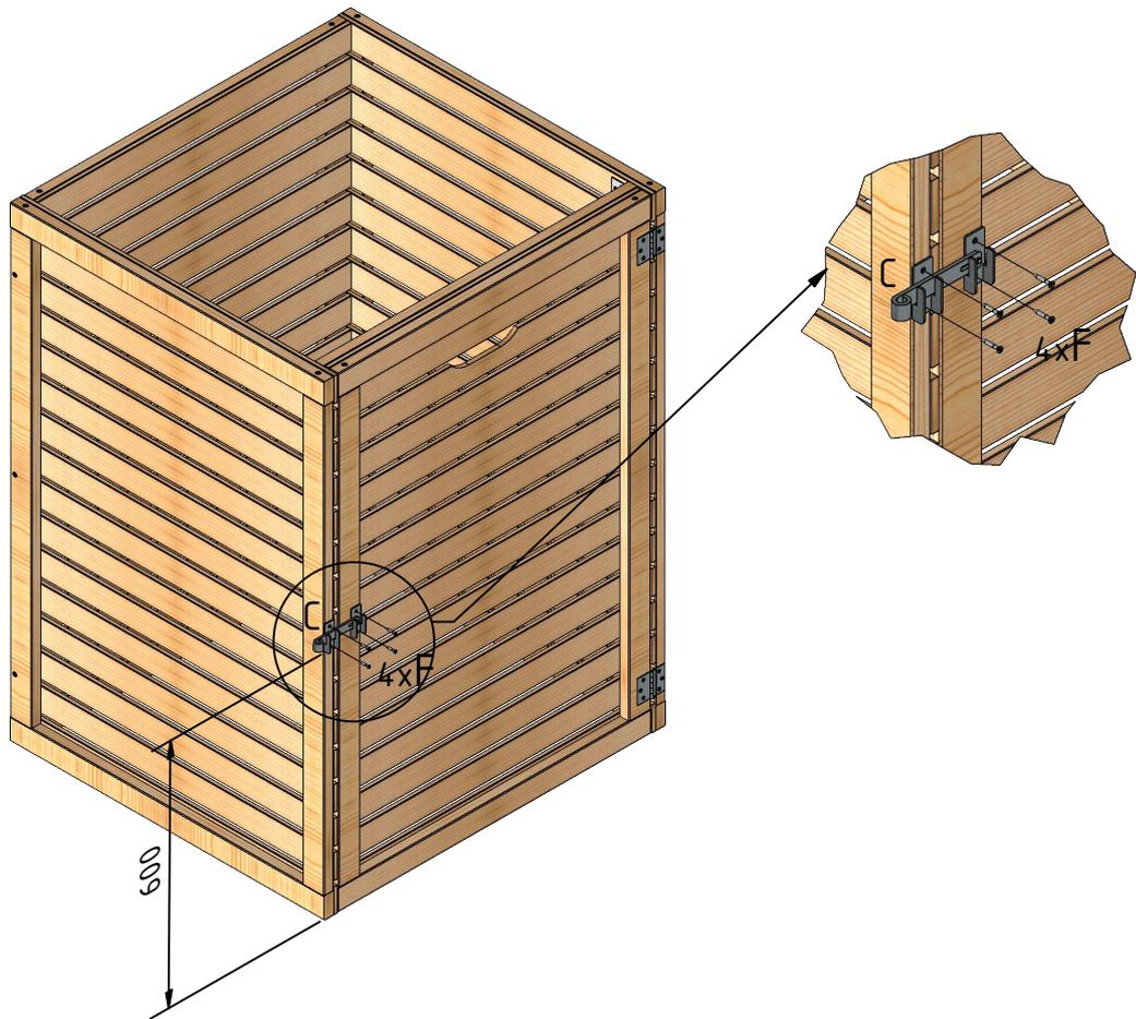
Überwurf (C) mit Schrauben (F) befestigen
