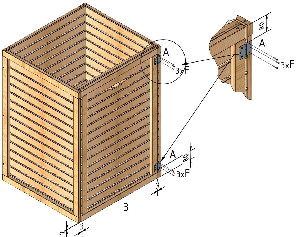
Die Türe (3) mit den Scharnieren (A), an den Korpus mit Schraube (F) befestigen
