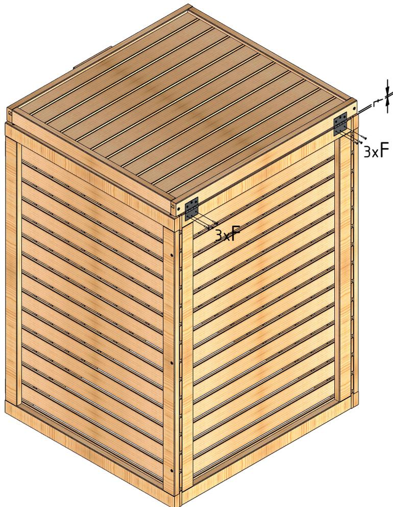
Deckel (1) mit der Schraube (F) an der Rückwand (2) anschrauben
