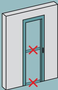
**9** Die Querstreben werden erst abgebaut, nachdem Sie die Zarge zu der anliegenden Wand befestigt haben und den geforderten konstanten Durchgang entlang der ganzen Höhe der Zarge garantieren können.
