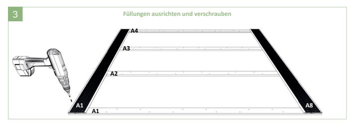
3 | Die beiden äußersten Füllungen im gleichen Abstand wie die der Löcher von den Querriegeln ausrichten. Die Füllung mit den mitgelieferten Schrauben befestigen. Auf ein geringes Drehmoment des Akkuschraubers achten, um Beschädigungen am Material zu vermeiden. Die Füllungen mit der gekennzeichneten Seite zum Aluminium-Querriegel ausrichten.
