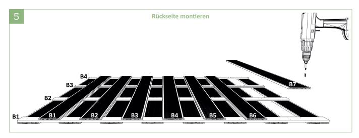
5 | Element vorsichtig drehen und rückseitig mit der Befestigung der verbleibenden Füllungen fortfahren. Weitere Montageschritte wie: Aufbau der Pfosten und Befestigung des Fertigzauns bitte der Montageanleitung "GroJaSolid | Fertigzaun" entnehmen.
