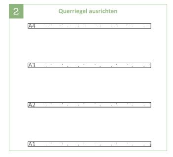
2 | Querriegel geschützt auf einen ebenen Untergrund legen. Der Abstand ergibt sich aus den vorgebohrten Löchern der Füllung. Bei den Querriegeln auf ein gleichmäßiges Bohrbild wie im Bild 2 achten. Die Kennzeichnung links ausrichten.
