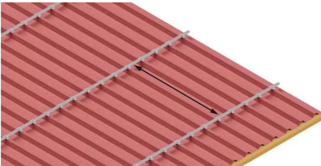
Abbildung 79 Abstand = Modullänge + 20 mm
