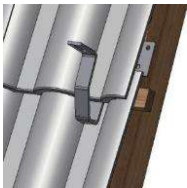
Abbildung 6 Dachhaken auf Dachsparren
