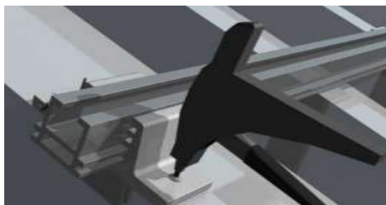
Abbildung 70 Vernieten mit Standard-Nietkopf
