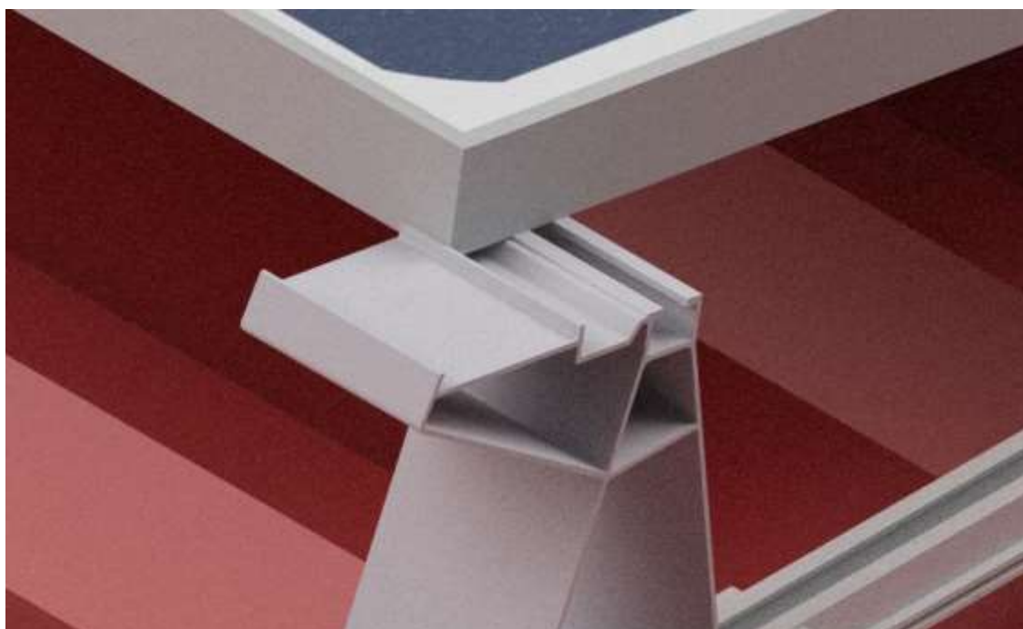
Abbildung 89 Modul muss am Anschlag der „Stütze oben“ (mit Windblechabschluss) anliegen
