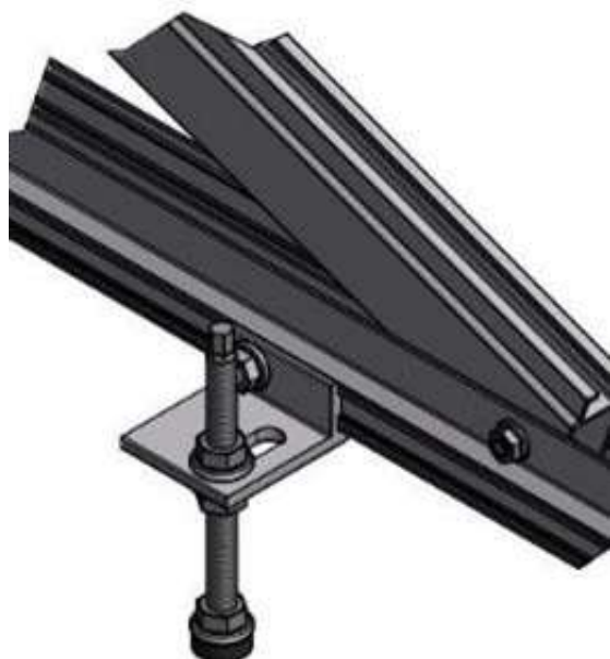
Abbildung 143 Montage mit einem Universalverbinder
