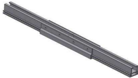
Abbildung 78 Aneinanderfügen der Profile
