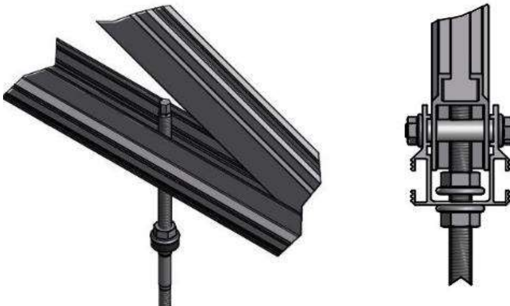
Abbildung 142 Montage mit einer Stockschraube
