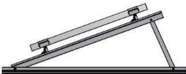
Abbildung 146 Modulmontage quer mit Modulträgerprofil
