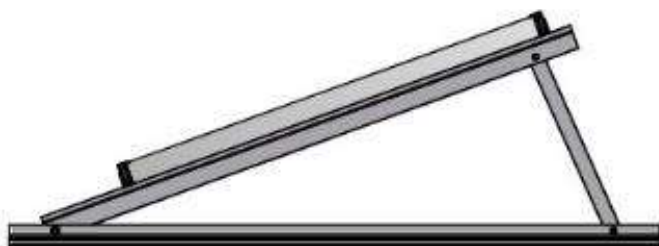
Abbildung 147 Modulmontage quer ohne Modulträgerprofil
