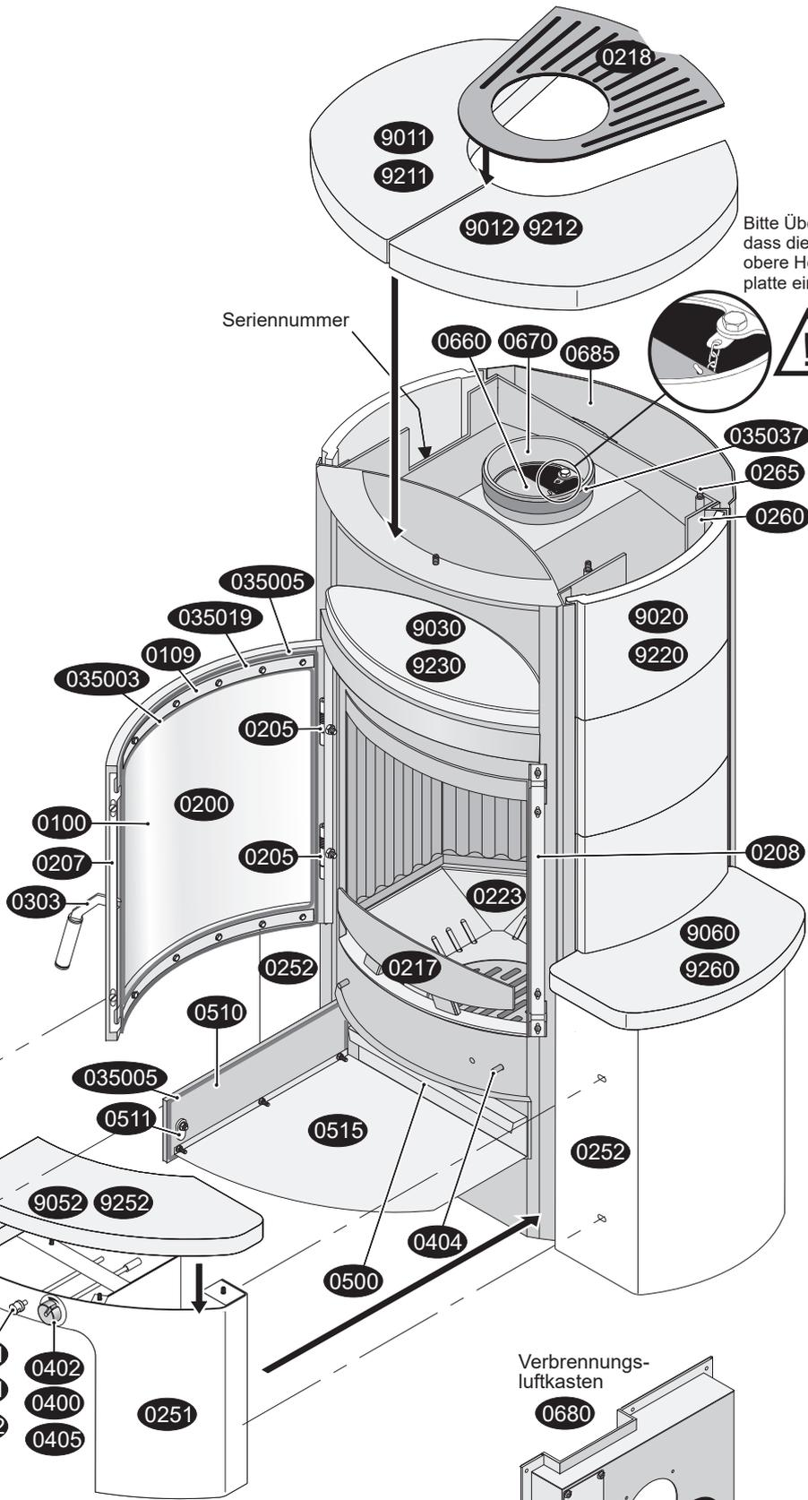
Bitte überprüfen Sie, dass die Kette in die obere Heizgasumlenkplatte eingehängt ist.
