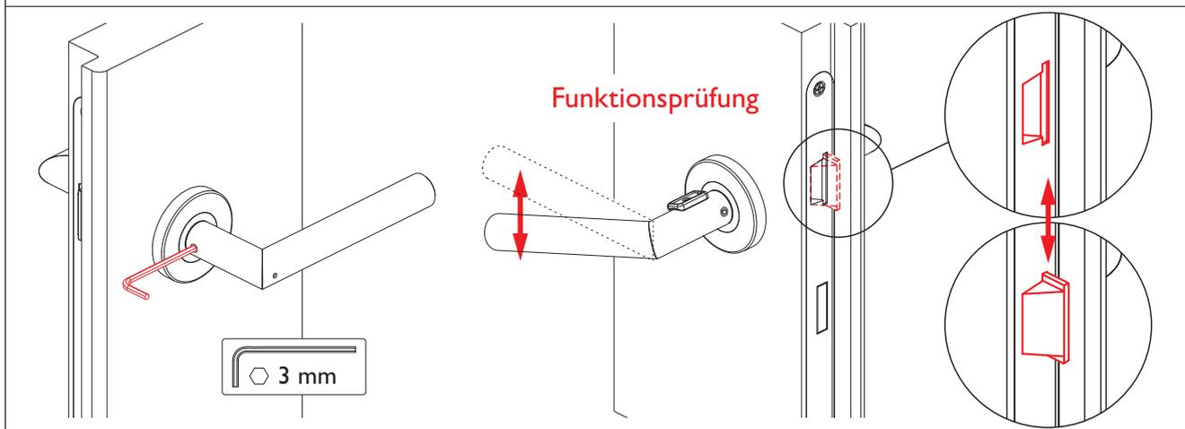
**!** Maximal 3 Nm Anzugskraft
