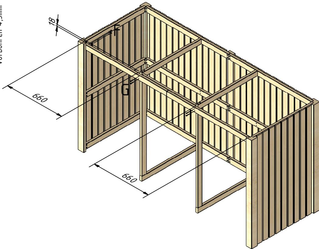
Das Leistenelement aus Schritt 7 mittig mit Schraube (G) und seitlich mit Schraube (F) lt. Vorgabe in den Korpus einschrauben. Das Element muss 18 mm tiefer sitzen als die Oberseite des Eckpfostens (7)!
