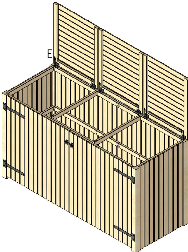
Deckel (5) am Korpus mit Schraube (E) befestigen. Rechts und Links bündig mit den Eckpfosten (7). Den mittleren Deckel vermitteln!
