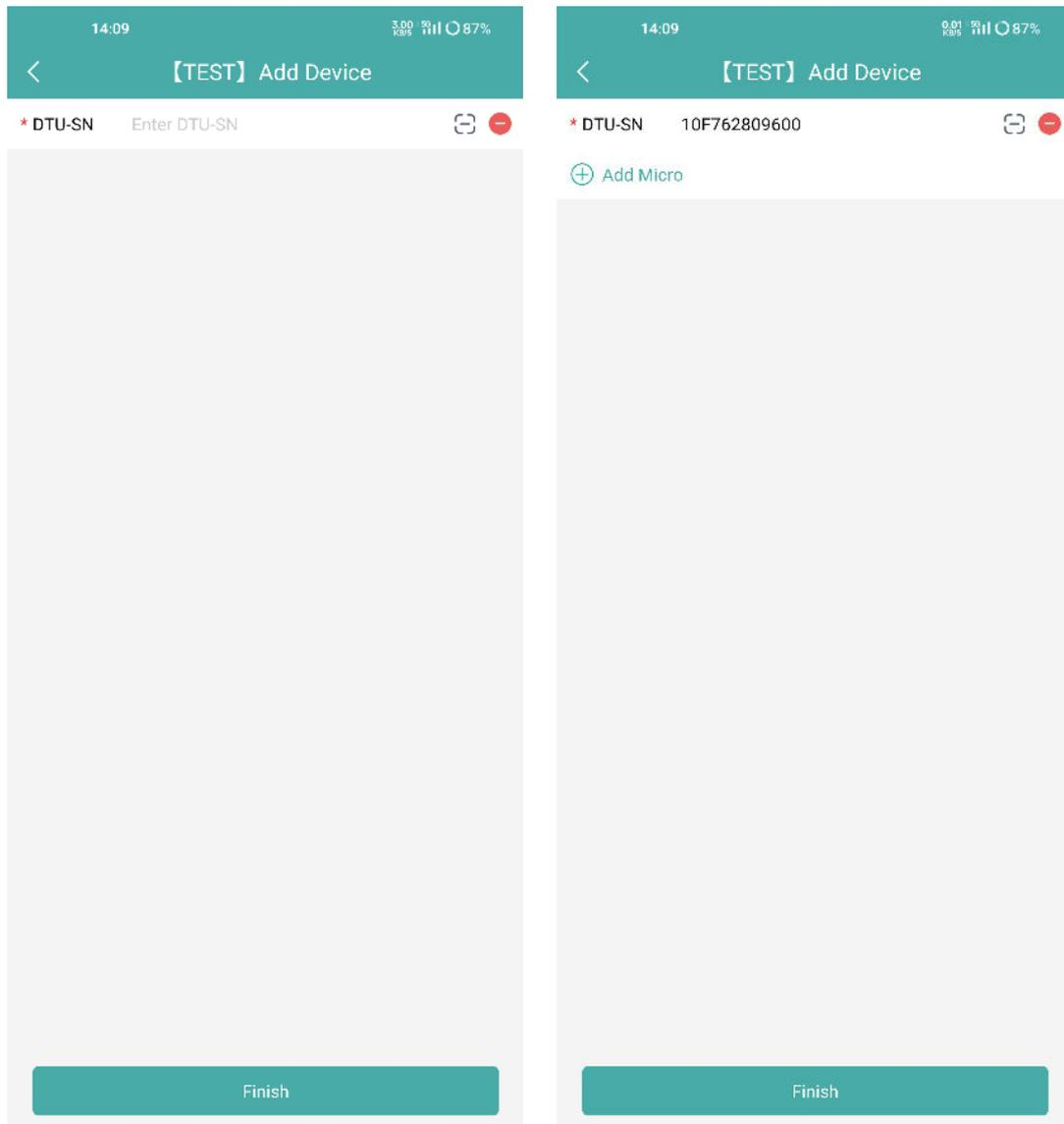
8) Fügen Sie Ihren Mikro-Wechselrichter hinzu, indem Sie die SN des Mikro-Wechselrichters manuell eingeben oder den SN-Aufkleber scannen.
