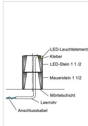
Anschlusskabel vom LED-Leuchtelement über die schmale Einkerbung durch das Schutzrohr führen.
