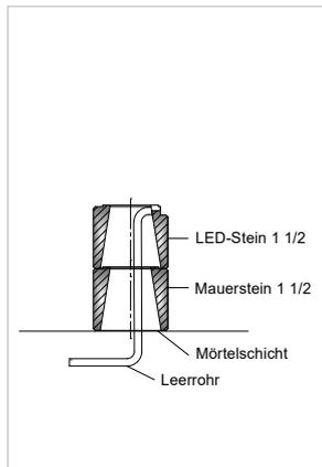
Mauersteine lagenweise auf die Höhe der Abschlusssteine mit Beton verfüllen.
