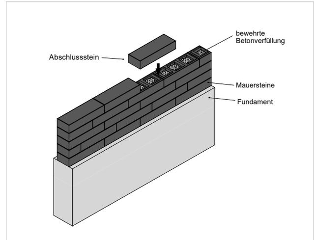
Die Mauersteine werden lagenweise mit erdfuchtem Beton verfüllt und mit einer geeigneten Leiste verdichtet. Der Beton der oberen Schicht wird leicht erhöht eingebracht und danach die Abschlusssteine aufgesetzt.
