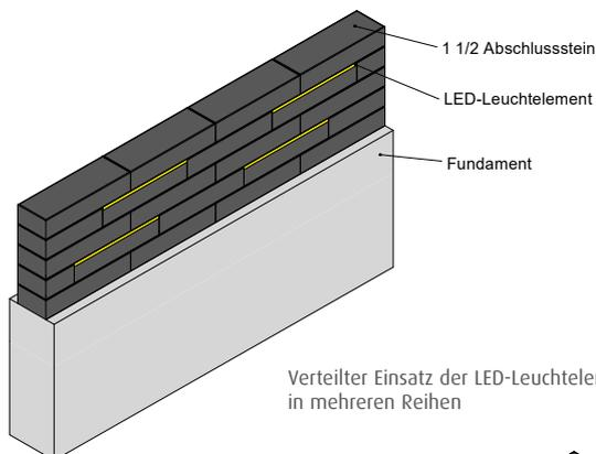
Verteilter Einsatz der LED-Leuchtelemente in mehreren Reihen
