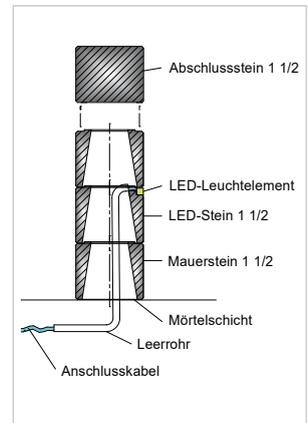
LED-Leuchtelement mit geeignetem Kleber vollflächig in der Kerbe verkleben.
