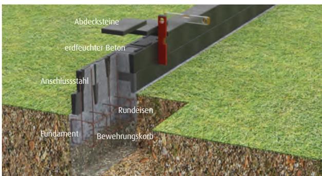
Den Beton der oberen Schicht wird leicht erhöht eingebracht und danach die Abdecksteine aufgesetzt. Die Stoßfugen der Abdeckungen sind mit einem geeigneten dauerelastischen Fugenmaterial (z. B. auf Polyurethanbasis) gegen eindringendes Wasser zu verschließen.
