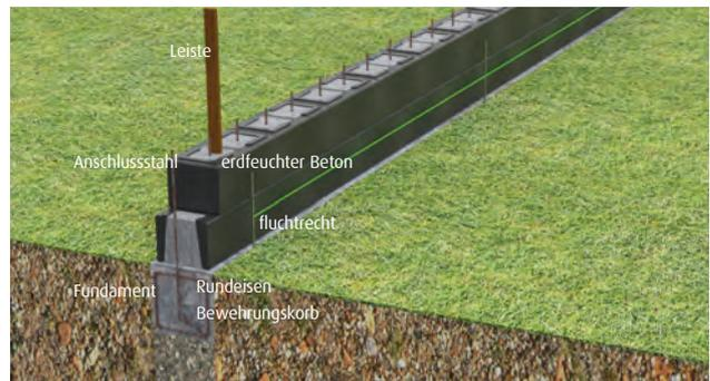
Die Mauersteine werden lagenweise mit erdfeuchtem Beton verfüllt und mit einer geeigneten Leiste verdichtet.
