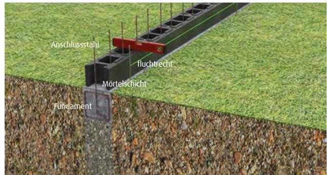
Die erste Schicht der Mauersteine muss absolut fluchtrecht und waagrecht in eine Zementmörtelschicht verlegt werden. Wir empfehlen Trasszement. Hiernach ist eine Ruhepause ratsam.
