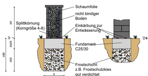
Nichtbindiger Boden ist ein Boden mit einem geringen Anteil an Feinkorn. Zu dieser Bodenart zählen Sand und Kies in verschiedenen Korngrößen und Mischungen. Bei der Verdichtung von nichtbindigen Böden wie bei Sanden und Kiesen werden die Körner in eine dichtere Packung umgelagert, wobei kleinere Körner die Poren zwischen größeren Körnern ausfüllen.
