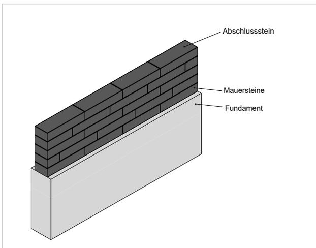
Das moderne lange Format sorgt für eine einheitliche Optik durch weniger Fugen und gleichformatige Mauersteine sowie für zusätzliche Stabilität durch das erhöhte Eigengewicht des Abschlusssteins.
