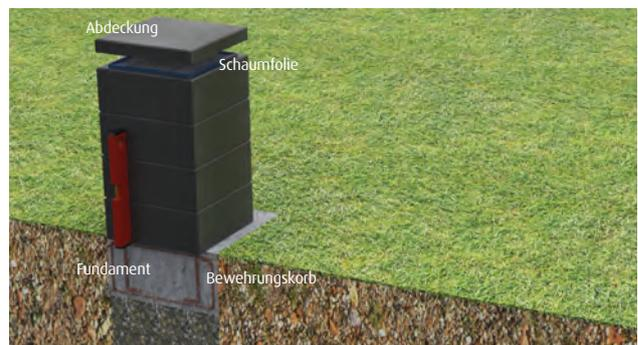
Der Beton der oberen Schicht wird leicht erhöht dachförmig eingebracht und danach die Pfeilerabdeckung aufgesetzt. Der Füllmengenbedarf kann separat angefordert werden.
