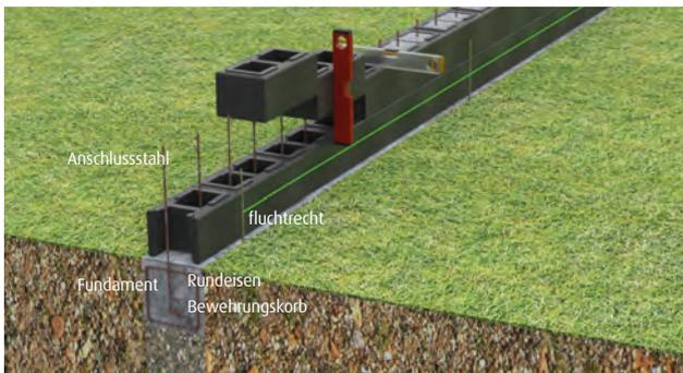
Beim lagenweisen Aufsetzen der weiteren Mauersteine ist ein lotrechter sowie auch weiterhin ein fluchtrechter und waagerechter Aufbau zu beachten. Evtl. fertigungsbedingte Maßtoleranzen sind auszugleichen (z. B. von der Innenseite mit einem Fliesenkeil).
