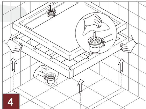
**4.** Träger und Wanne werden zur Seite gestellt. Das Siphongehäuse bleibt angeschlossen und die Öffnung wird gegen Verschmutzung abgedeckt.
