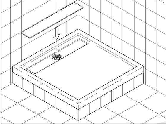
**Variante II:** Montage mit Hartschaumträger. Bei dieser Montage ist keine Vertiefung im Untergrund notwendig. Duschwanne mit Träger ist ca. 160-175mm hoch.
