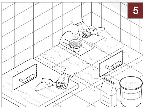
5. Flex-Fiesenkleber auf beide Oberflächen (Untergrund u. Unterseite der Duschwanne) mit Zahnpachtel auftragen.
