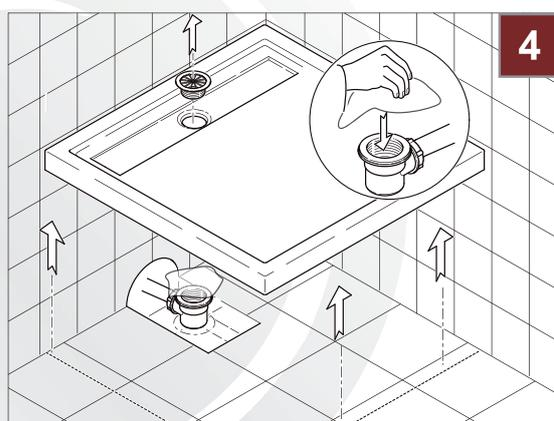
4. Ablaufdeckel/Verschraubung wird wieder entfernt und die Duschwanne zur Seite gestellt. Das Siphongehäuse bleibt montiert und die Öffnung wird gegen Verschmutzung abgedeckt.
