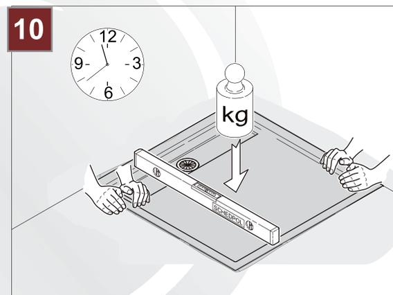
10. Nach einer ausreichenden Austrocknung des Klebers (ca. 24h) kann mit dem Verfliesen begonnen werden.
