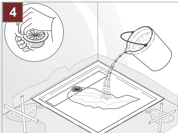
4. Siphon wird in der vormarkierten Stelle montiert und der Träger muss entsprechend herausgeschnitten werden.
