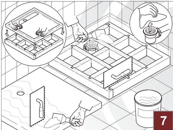
7. Flex-Fliesenkleber wird auf die Oberseite des Tragers und auf die Unterseite der Duschwanne mit einer Zahnschachtel aufgetragen. Schutzabdeckung vom Siphongehause entfernen und Siphondichtung anbringen. Die Duschwanne wird vollflachig mit dem Trager verklebt. Achtung! Die Dichtung und das Siphongehause nicht mit dem Kleber in Berahrung bringen.
