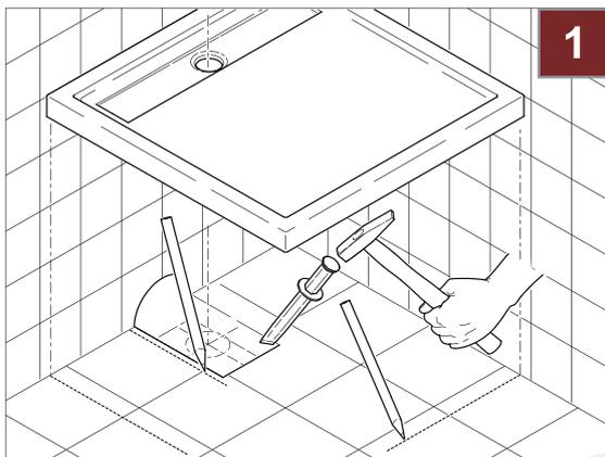
1. In den jeweiligen Untergrund wird eine Vertiefung für das Siphongehäuse und das Anschlussrohr eingebracht. Die Vertiefung muss eine geräumige Montage des Ablaufes ermöglichen. **Achtung!** Die Aufstellfläche soll eben und stabil, vollflächig sein und keine sichtbaren Risse aufweisen..
