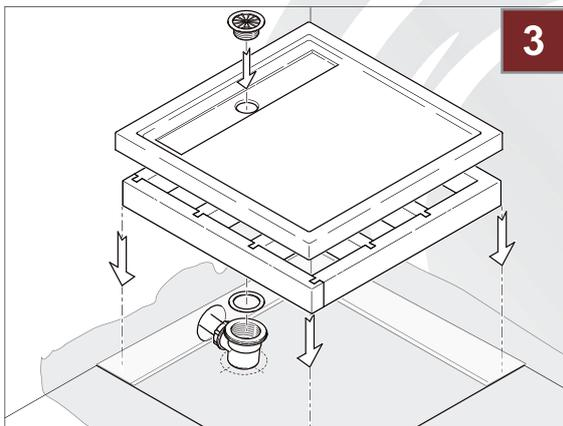
3. Beachten Sie die korrekte Isolierung geg. Nässe im ges. Spritzwasserbereich und der Aufstellfläche. Die Anschlussstelle des Trägers/der Duschwanne zur Wand soll mit Trittschalldämmstreifen isoliert werden.
