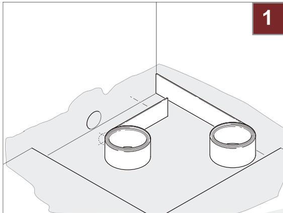
1. Wenn die Aussparung im Estrich nicht gewährleistet ist, muss eine Vertiefung entsprechend der Duschwannengröße und ihrer Einbauhöhe hergestellt werden. Es wird empfohlen, die bodenbündige Montage mit dem Hartschaumträger auszuführen.
