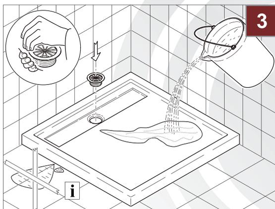
3. Duschwanne wird am Installationsort aufgestellt und der kompl. Ablauf mit notwendigen Dichtungen wird angeschlossen. Es folgt eine Dichtigkeitsprüfung. Ist der Ablauf dicht, kann mit der abschließenden Montage begonnen werden.
