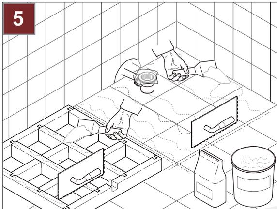
5. Auf beide Oberflachen (Untergrund und Unterseite des Tragers) wird Kleber (Flex-Fliesenkleber) mit Zahnschachtel aufgetragen.
