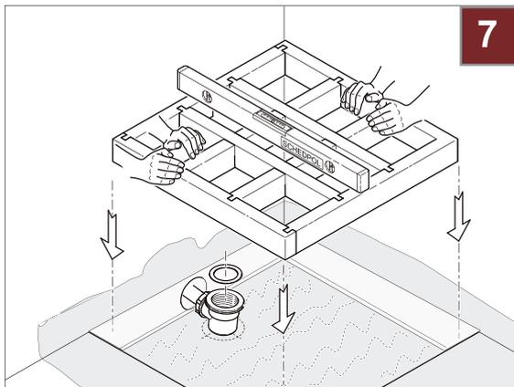
7. Auf beide Flächen, Boden und Unterseite des Trägers, Kleber auftragen und den Träger waagrecht ausrichten. Beachten Sie bitte den korrekten Abstand zur Wand.
