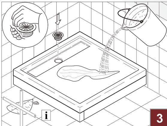
**3.** Duschwanne und Träger werden am Installationsort aufgestellt und der kompl. Ablauf mit notwendigen Dichtungen wird angeschlossen. Es folgt eine Dichtigkeitsprüfung. Ist der Ablauf dicht, kann mit der abschließenden Montage begonnen werden.
