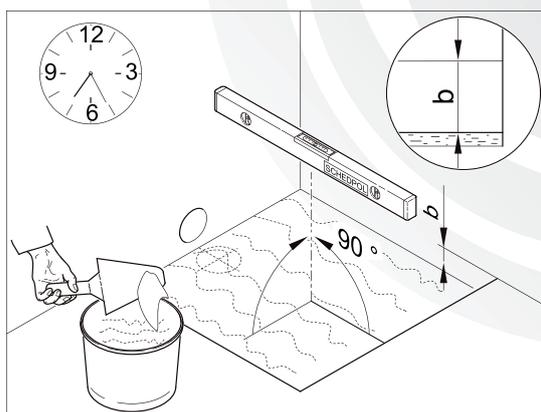
b=Vertiefung im Boden=ges. Höhe des Trägers mit der Duschwanne
