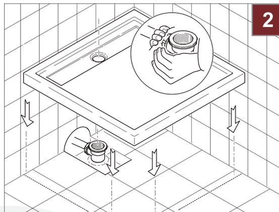
2. Das Siphongehäuse wird mit dem Abwasserrohr verbunden.
