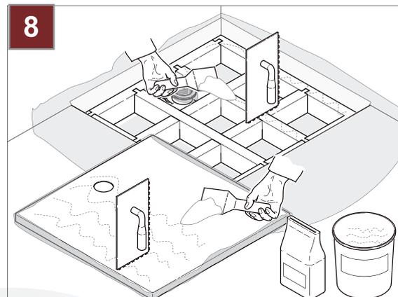
8, 9 Auf den Träger und die Unterseite der Duschwanne Kleber auftragen und waagrecht zusammen kleben. Achtung! Vorher die Schutzabdeckung vom Siphon abnehmen und die Dichtung aufsetzen.
