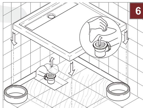
6. Schutzabdeckung vom Siphongehäuse entfernen, Siphondichtung anbringen und die Duschwanne mit dem Untergrund verkleben. Achtung! Siphongehäuse und Dichtung nicht mit Kleber in Berührung bringen.
