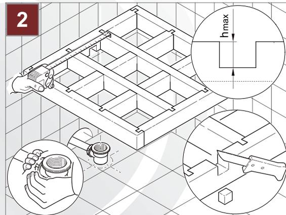
**2.** Im Träger wird das Siphongehäuse in der entsprechenden Aussparung positioniert und mit dem Abflussrohr verbunden. Der Träger kann dazu an der erforderlichen Stelle zugeschnitten werden.
