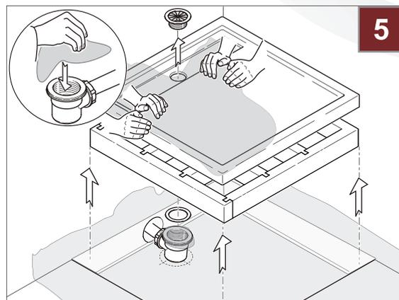
5. Duschwanne mit dem Träger werden trocken aufgesetzt, Siphon montiert und auf Dichtigkeit geprüft.
