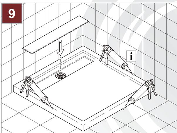
8. Die Fugen am Boden und zu den Wänden mit Sanitär-silikon abdichten. Die Abdeckplatte kann eingelegt werden.
