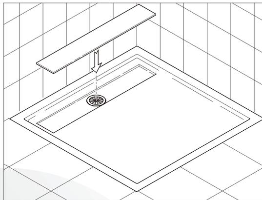
**ANMERKUNG!** Bei Wandverfließen auf den Wannenrand muss das geringere Aufstellmaß für die Duschkabine beachtet werden. Dies sollte vorher unbedingt geprüft und ggf. die Einbauweise (Wandverfließen) geändert werden.
