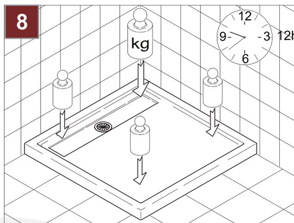
7,8. Duschwanne waagrecht ausrichten. Der Ablauf wird vorläufig verschraubt und erst nach voller Austrocknung des Klebers richtig festgezogen.
