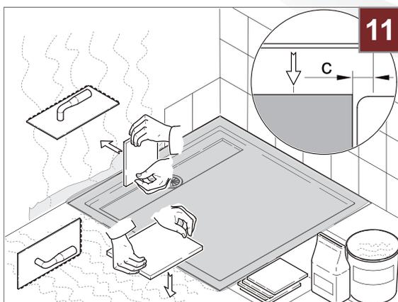
11. Bei der Verfliesung von Boden darauf achten, dass zwischen dem Duschwannenrand und der angrenzenden Bodenfliese eine Fuge (c) von ca. 5 mm frei bleibt, die zum Schluß mit Silikon ausgefügt wird.
