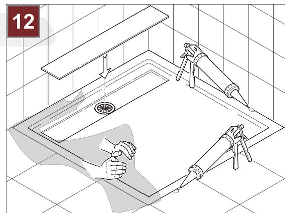
12. Nach Austrocknung der Fugenmasse wird die Schutzabdeckung abgenommen und die Anschlussstellen Dusche-Wand-Boden werden mit Silikon verdichtet.
