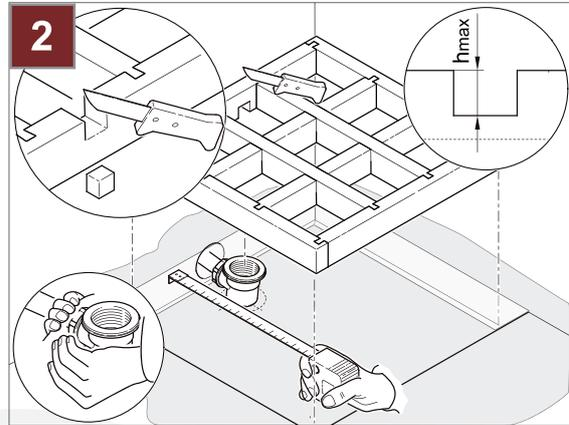
2. Die Aufstellfläche soll eben stabil und vollflächig sein und keine sichtbaren Risse aufweisen.
