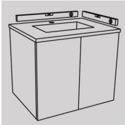
Het meubel moet op vlakke manier en waterpas worden gemonteerd in overeenstemming met de aanbevelingen in onze installatiehandleiding. Zoals ook in de handleiding vermeld, moet u siliconen aanbrengen om waterdichtheid te garanderen.
