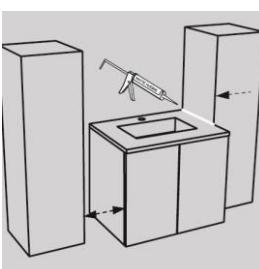
Zie erop toe dat er voldoende ruimte is tussen de kolom en het wastafelmeubel om te voorkomen dat er een ruimte ontstaat waar water kan blijven staan. Anders moet u beslist een afdichting tussen het wastafelmeubel en de kolom aanbrengen.
