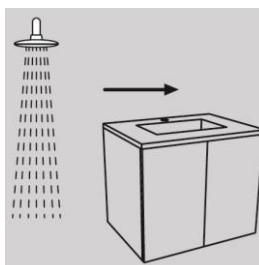
Om dezelfde reden, laat u een ruimte van ten minste 1 meter tussen uw meubels en uw watertappunten (douche, badkuip, bidet, ...) of laat een waterdichte wand installeren om spatwater of ophoping van water te voorkomen.
