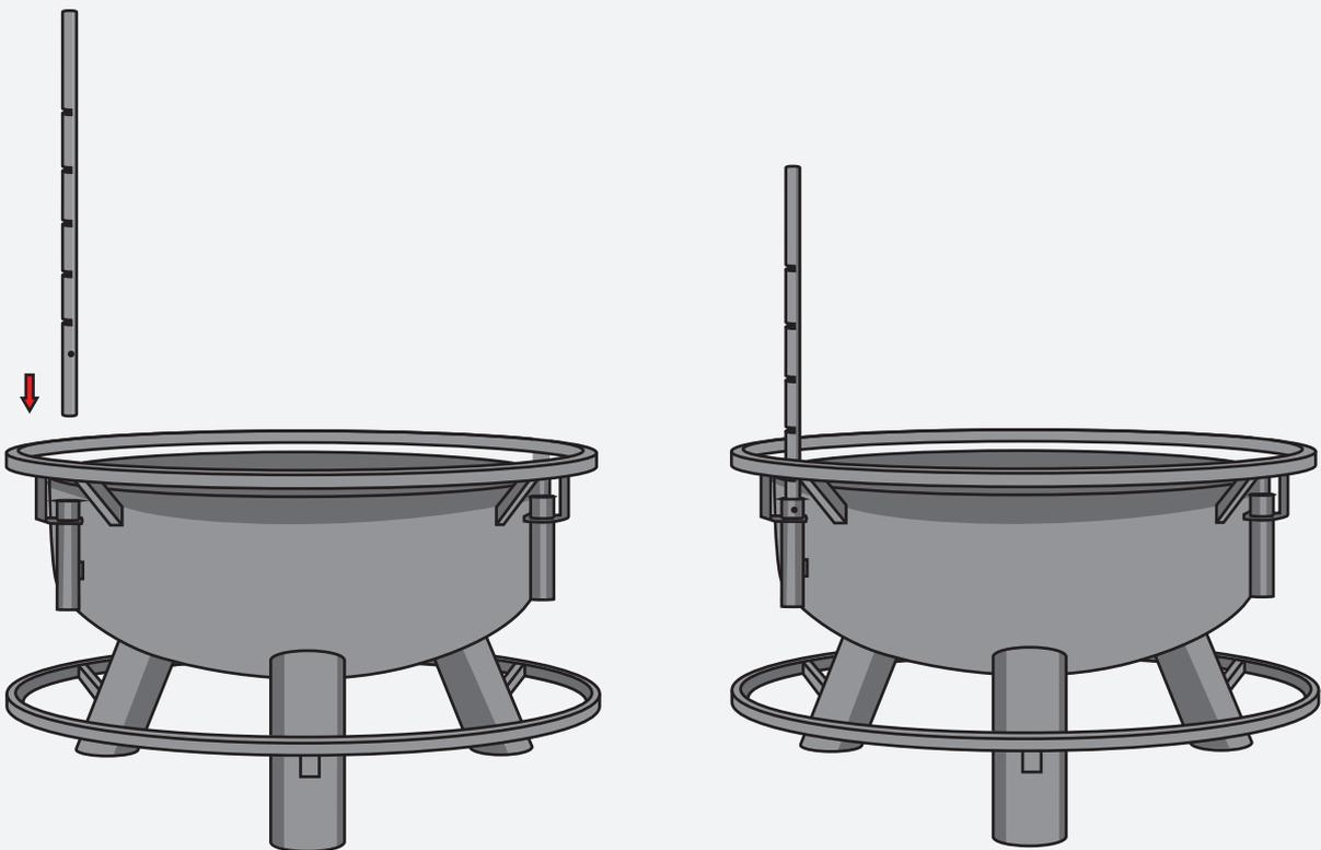
3. Der Mast verfügt über Einkerbungen, mit denen das montierte Zubehör befestigt wird.
