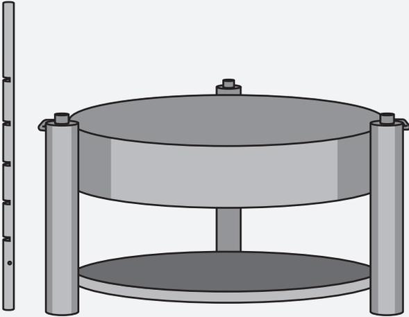
Nach dem Einsetzen in die Halterung sichert die Verriegelung den Mast in der richtigen Position und verhindert, dass er sich vertikal und horizontal bewegt:
