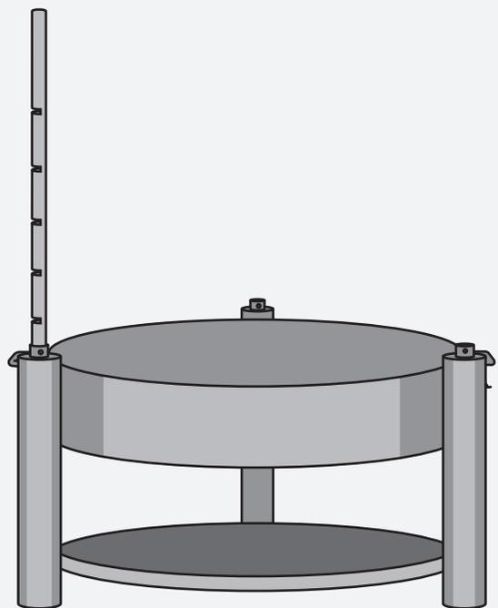
3. Der Mast verfügt über Einkerbungen, mit denen das montierte Zubehör befestigt wird.
