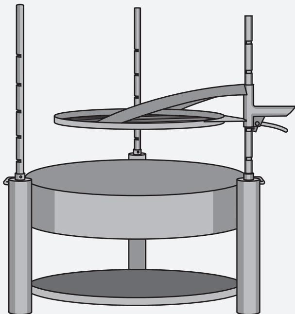
5. Aus Sicherheitsgründen kann nur ein Zubehörteil an einem einzigen Mast verwendet werden.
