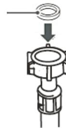
2. Befestigen Sie das **gerade** Ende des Wasserzulaufschlauchs an dem entsprechenden Wasseranschluss (s. Abb. rechts). Drehen Sie den Schlauch **per Hand** fest; verwenden Sie **keine** Zange oder ähnliche Werkzeuge.
