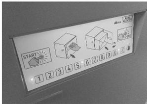
Nach dem Einlegen der Batterien wird eine automatische Kalibrierung gestartet. Hierbei leuchten alle LEDs der eBoxx für eine Sekunde auf und das eBoxx easy+ Schloss wird mehrmals geöffnet und geschlossen. Nach der Kalibrierung befindet sich das Schloss im Status „Offen“. Bitte verschließen Sie die Tür nicht und führen Sie die folgenden Schritte unmittelbar und bei geöffneter Tür durch.
