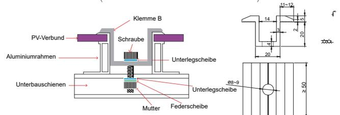
Klemme B Die am mittleren Modul verwendete Klemme
