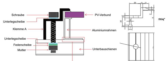
Die Oberfläche des Modulrahmens überlappt die Führungsschiene um mindestens 20 mm
