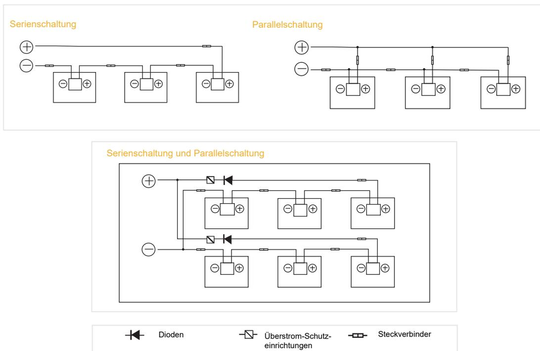
Abbildung 4: Schaltpläne von seriellen und parallelen Schaltungen
