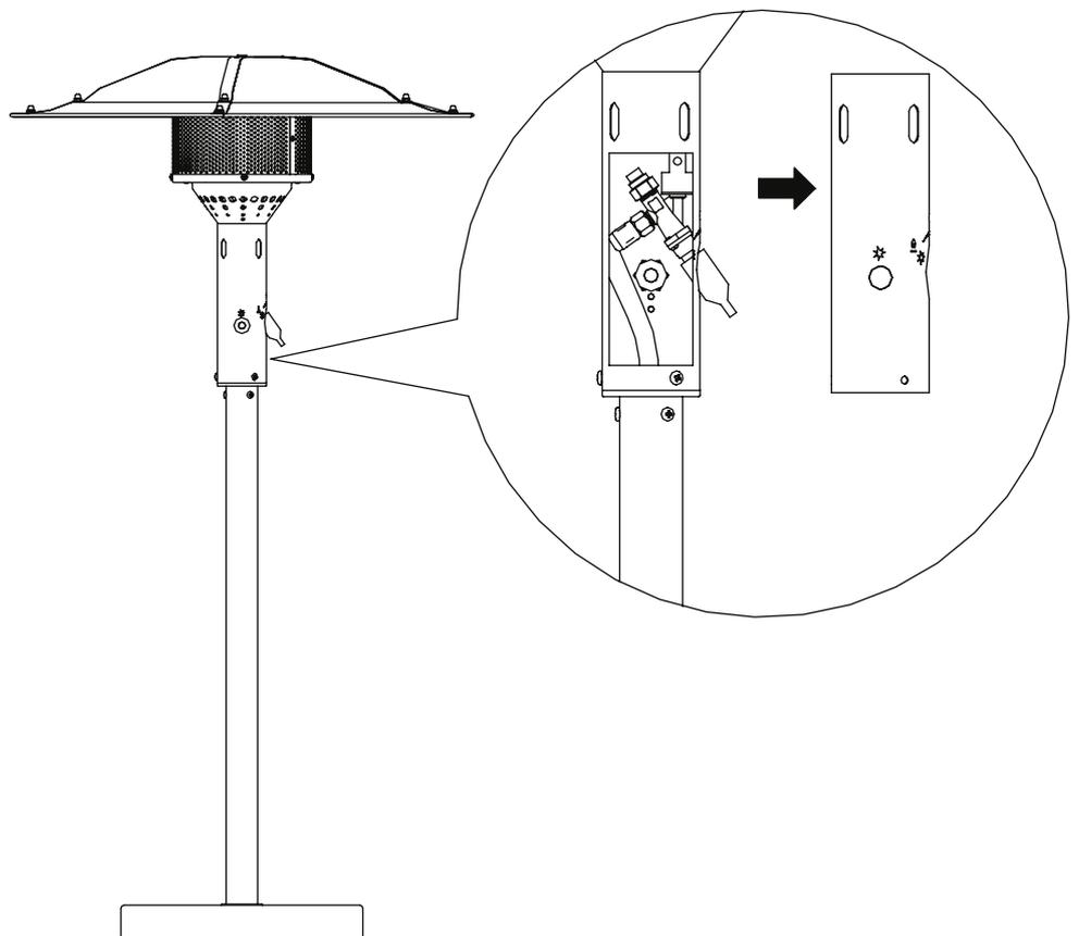
Lösen Sie die Überwurfmutter des Gasschlauches durch Rechtsdrehung und ersetzen ihn durch einen neuen. Die Überwurfmutter durch Linksdrehung mit dem Gewinde des Gashahns verbinden und mit einem geeigneten Schraubenschlüssel fest anziehen. Nach der Dichtheitsprüfung bringen Sie den Clip wieder an.
