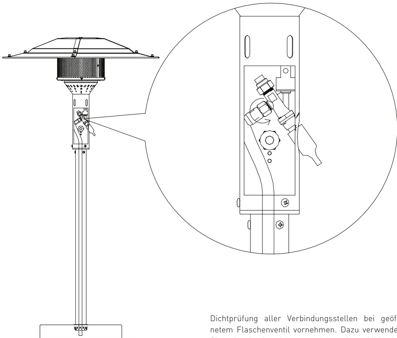
Dichtprüfung aller Verbindungsstellen bei geöffnetem Flaschenventil vornehmen. Dazu verwenden Sie ein Lecksuchspray oder schaubildendes Mittel (z.B. Gas-Control-Spray oder Seifenlauge). Dieses bringen Sie an den Verbindungsstellen des Schlauches auf. Die Dichtheit ist sichergestellt, wenn sich keine Blasenbildung zeigt.
