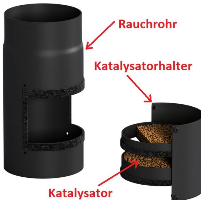
Entwickelt von Accente Products GmbH, verfügt der Accente Sauberling über eine einzigartige, katalytisch wirksame Beschichtung. Diese Beschichtung, zusammen mit den spezifischen Kanalstrukturen des keramischen Filters, ermöglicht es ihm, Rauchgase (insbesondere Kohlenstoffmonoxid und Kohlenwasserstoffe), die im Kaminofen entstehen, effizient zu verringern.
