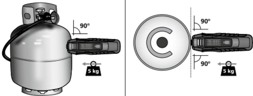
Ölçüm başlığını dikey şekilde silindir yüzeyine yerleştirin ve bu pozisyonda bastırın.
