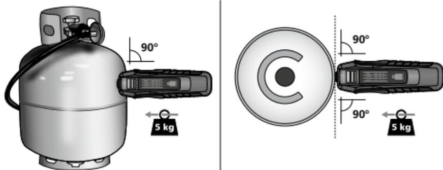
Встановіть вимірювальну голівку вертикально зверху балона та натисніть на неї в цьому положенні.
