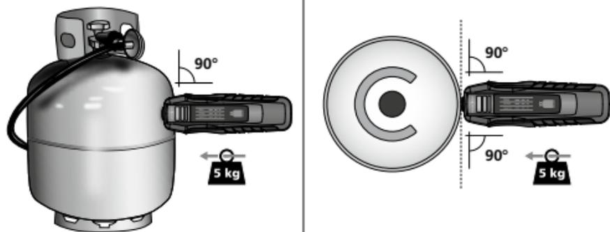
Měřicí hlavici přiložte kolmo k povrchu válce a v této poloze přitlačte. Během měření držte měřicí hlavu klidně a teprve při negativním optickém signálu (červená) lehce opravte.
