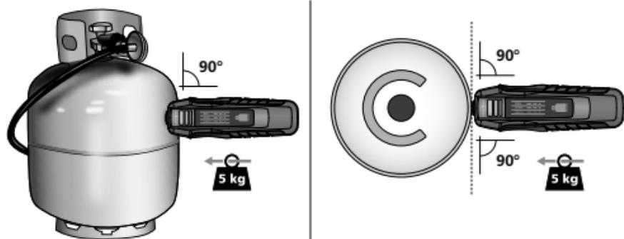
Τοποθετήστε την κεφαλή μέτρησης κάθετα επάνω στην επιφάνεια του κυλίνδρου και πιέστε σε αυτήν τη θέση.
