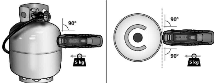
Aseta mittauspää pullon pinnalle pystysuoraan ja pidä sitä siinä asennossa.
