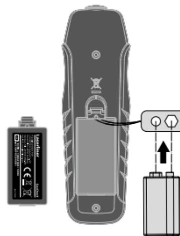
! Das Gerät ist nach Einsetzen der Batterien direkt betriebsbereit. Es verfügt über keinen gesonderten Ein-/Aus-Schalter und ist somit immer aktiv.
