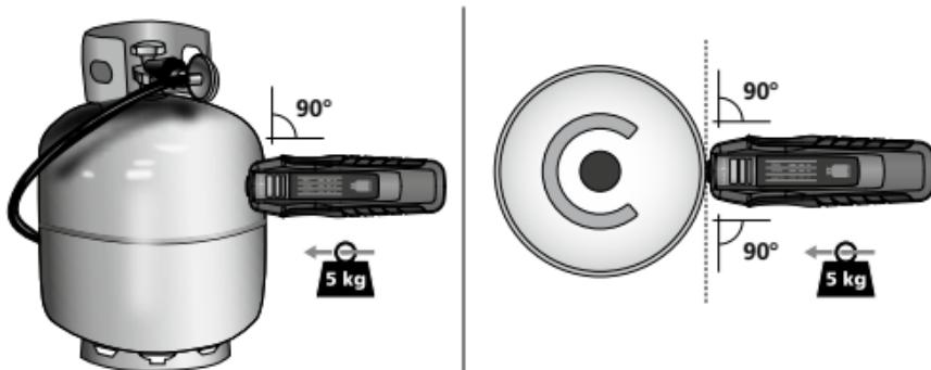
Coloque a cabeça de leitura perpendicular à superfície da botija e pressione-a nessa posição.
