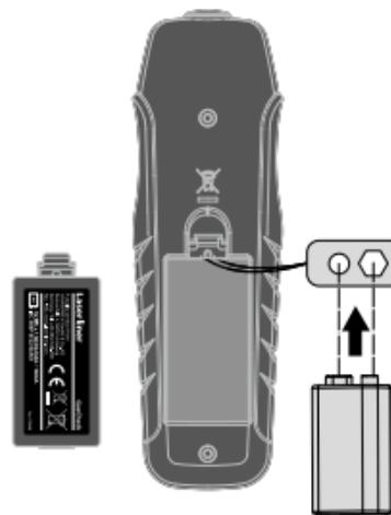
! Apparaten är klar att användas direkt efter att batterierna satts in. Den har ingen speciell PÅ-/AV-omkopplare och är därför alltid aktiv.
