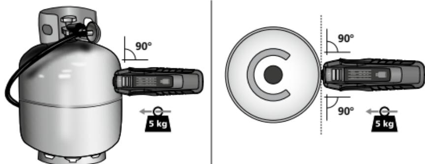
Appoggiare la testina di misura verticalmente sulla superficie del cilindro e fare pressione.
