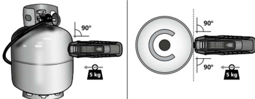
Plaats de meetkop verticaal op het cilinderoppervlak en druk hem in deze positie aan.
