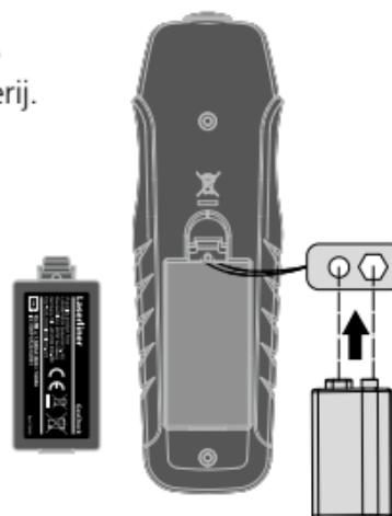
**!** Het apparaat is direct na het plaatsen van de batterijen klaar voor gebruik. Het apparaat heeft geen aparte aan-/uitschakelaar en is dus altijd actief.
