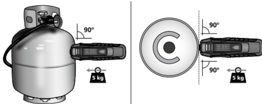
Poser la tête de mesure à la verticale sur la surface cylindrique et appuyer dans cette position.
