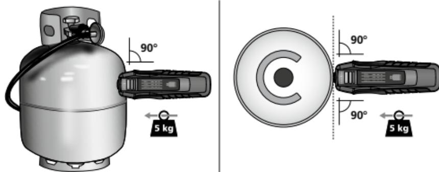
Colocar el cabezal de medición perpendicular sobre la superficie cilíndrica y presionarlo en esa posición.
