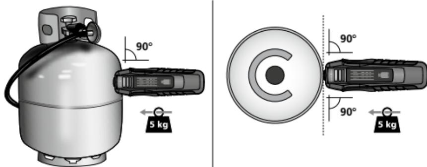
Målehovedet anbringes lodret på cylinderoverfladen og trykkes fast i denne position.
