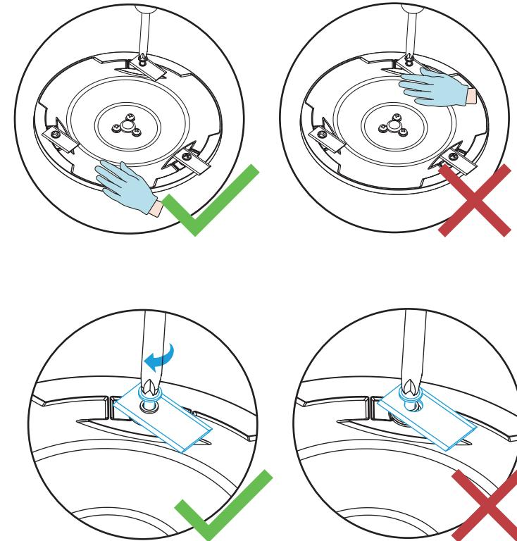
5. Vérifiez que les lames pivotent librement. Dans le cas contraire, desserrez les vis correspondantes et resserrez-les.
