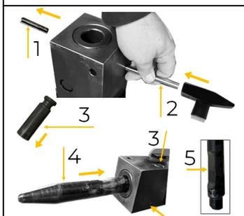
**(DE)** Federstift (1) mit dem Durchschlag (2) und Hammerschlägen entfernen.
