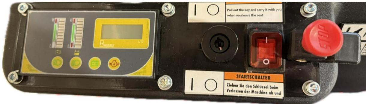
Die Anzeige dient der Überwachung mehrerer wichtiger Funktionen der Maschine. Die mittlere Anzeige zeigt den aktuellen Ladezustand der Batterie, die Betriebsstunden sowie Warnhinweise für den Ölstand und den Ladezustand der Batterie an. Zusätzlich informiert sie darüber, ob das Licht eingeschaltet ist. Die rechte Anzeige gibt Auskunft über den Füllstand des Kraftstofftanks, sodass der Betreiber stets den aktuellen Tankstatus im Blick behalten kann.
