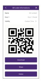
Innerhalb des Gültigkeitszeitraums wird der Zugang durch Vorhalten des QR-Codes vor die Kamera freigeschaltet. Halten Sie den Code aus ca. 20 cm Entfernung vor die Kamera. Klingeln ist nicht erforderlich.
