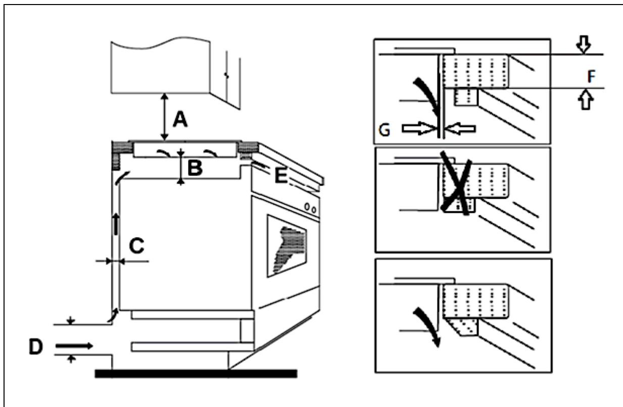
**C = BELÜFTUNGSSCHLITZ**
