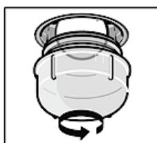
4. Entfernen Sie das Leuchtmittel aus der Fassung (s. Abb. unten) und ersetzen Sie dieses durch ein neues Hochtemperatur-Leuchtmittel (300 °C) **gleicher Art**: Volt 230 V / Leistung 25 W. Benutzen Sie **keinen** anderen Leuchtmittel-Typ.
