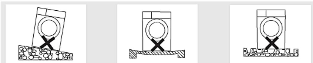
11. Falls Sie das Gerät auf einem Holzfußboden installieren, **müssen** Sie es zusätzlich auf eine **mindestens** 3,00 cm dicke Sperrholzplatte (60,00\*60,00 cm) stellen, um das Gewicht des Gerätes zu verteilen. Befestigen und sichern Sie die Sperrholzplatte ordnungsgemäß auf dem Holzfußboden.
