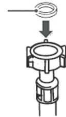
2. Befestigen Sie das **gerade** Ende des Wasserzulaufschlauchs an dem entsprechenden Wasseranschluss (s. Abb. rechts).
