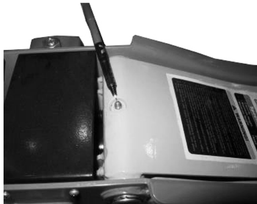
Abb. 8: Schmierstellen am Wagenheber
