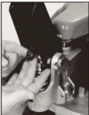
Abb.5-5: Einsetzen der Klemme
