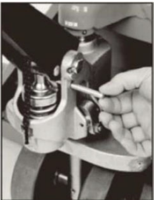
Abb.5-4: Entlasten der Rückholfeder
