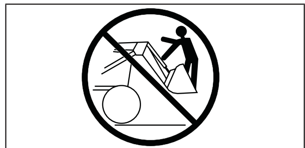
Abbildung 82 Verwenden Sie den Lader oder das Gerät NICHT zum Heben oder Transport von Personen.
