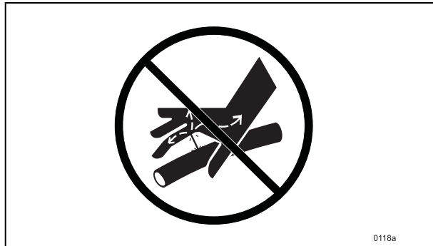
Abbildung 99 Verwenden Sie bei der Lecksuche UNTER KEINEN UMSTÄNDEN Finger oder Hände.
