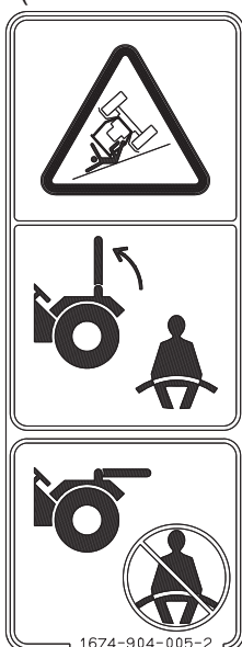
(12) Warnaufkleber für Überroll-Schutzbügel (Bestell-Nr. 1674-904-005-2)
