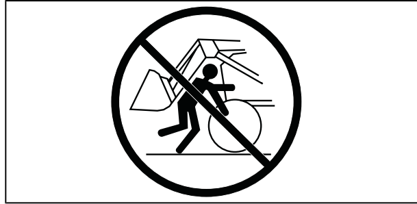
Abbildung 83 Unter einem angehobenen Lader NIE stehen, gehen oder arbeiten.
