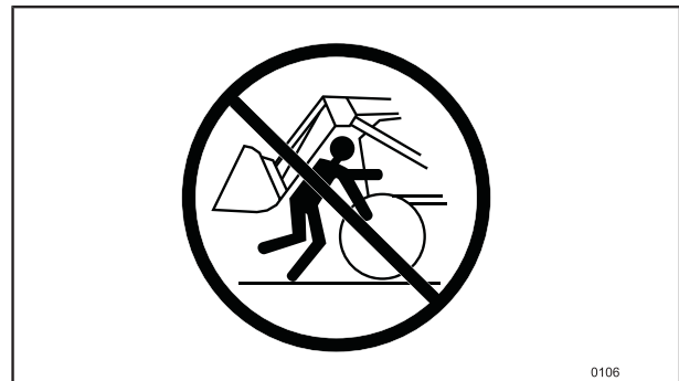
Abbildung 38 Unter einem angehobenen Lader NIE stehen, gehen oder arbeiten.
