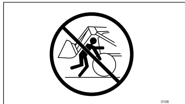
Abbildung 52 Stellen Sie sich niemals zwischen die Vorderseite des Traktors und den Lader.
