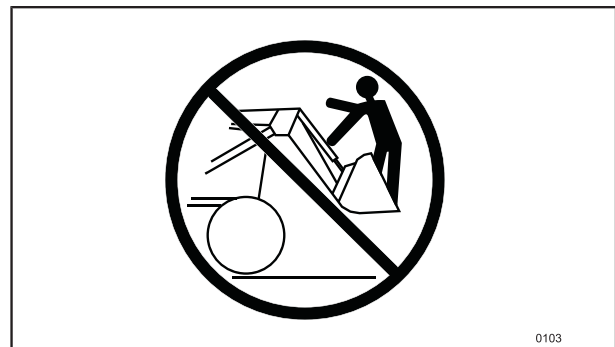
Abbildung 37 Verwenden Sie den Lader oder das Gerät NICHT zum Heben oder Transport von Personen.
