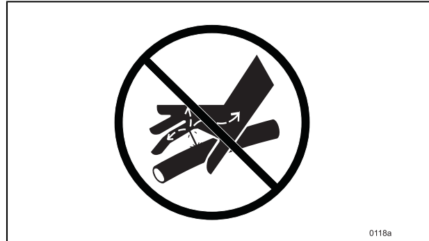
Abbildung 101 Verwenden Sie bei der Lecksuche UNTER KEINEN UMSTÄNDEN Finger oder Hände.
