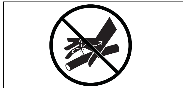
Abbildung 23 Verwenden Sie bei der Lecksuche UNTER KEINEN UMSTÄNDEN Finger oder Hände.
