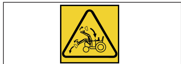
Abbildung 39 Behalten Sie das Anbaugerät im Blick. Es können Gegenstände nach hinten auf den Fahrer rollen.
