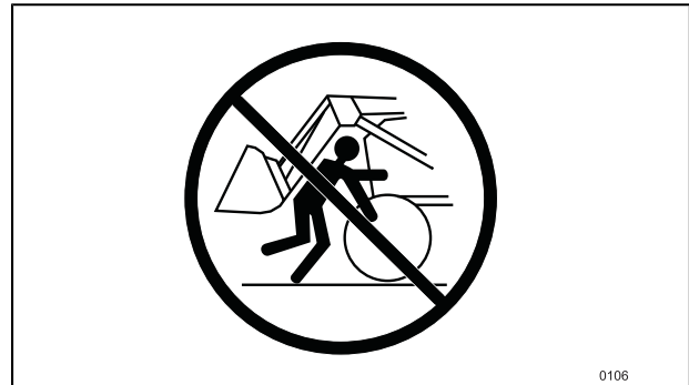
Abbildung 97 Stellen Sie sich niemals zwischen die Vorderseite des Traktors und den Lader.
