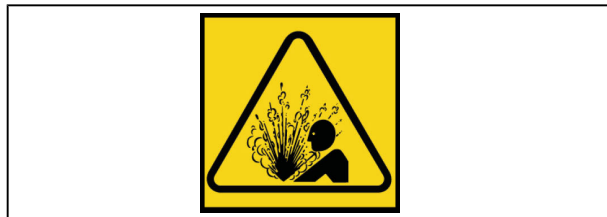
Abbildung 100 Warnung vor unter Druck stehender Hydraulikflüssigkeit
