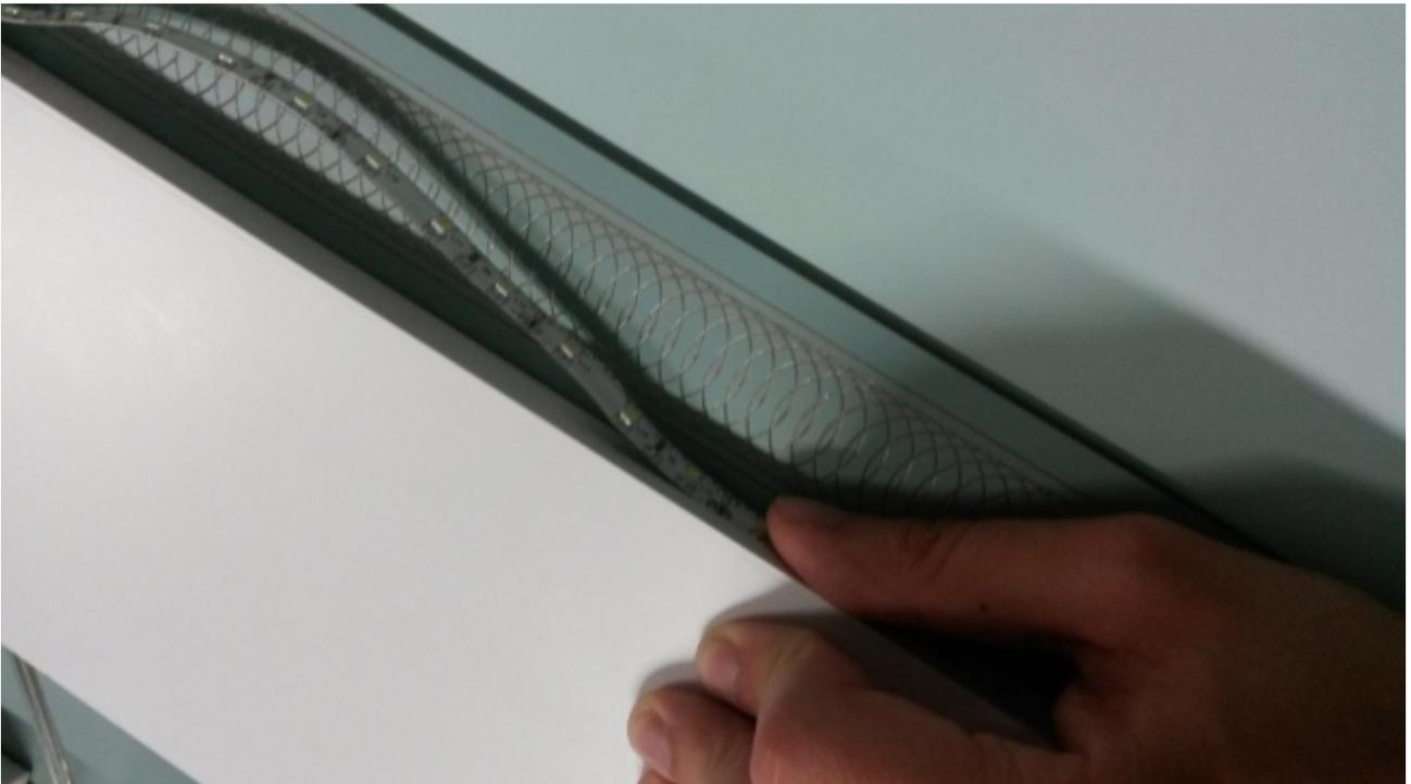
Schutzfolie vom Klebestreifen am neuen LED Band abziehen und am Rahmen des Spiegels ankleben
